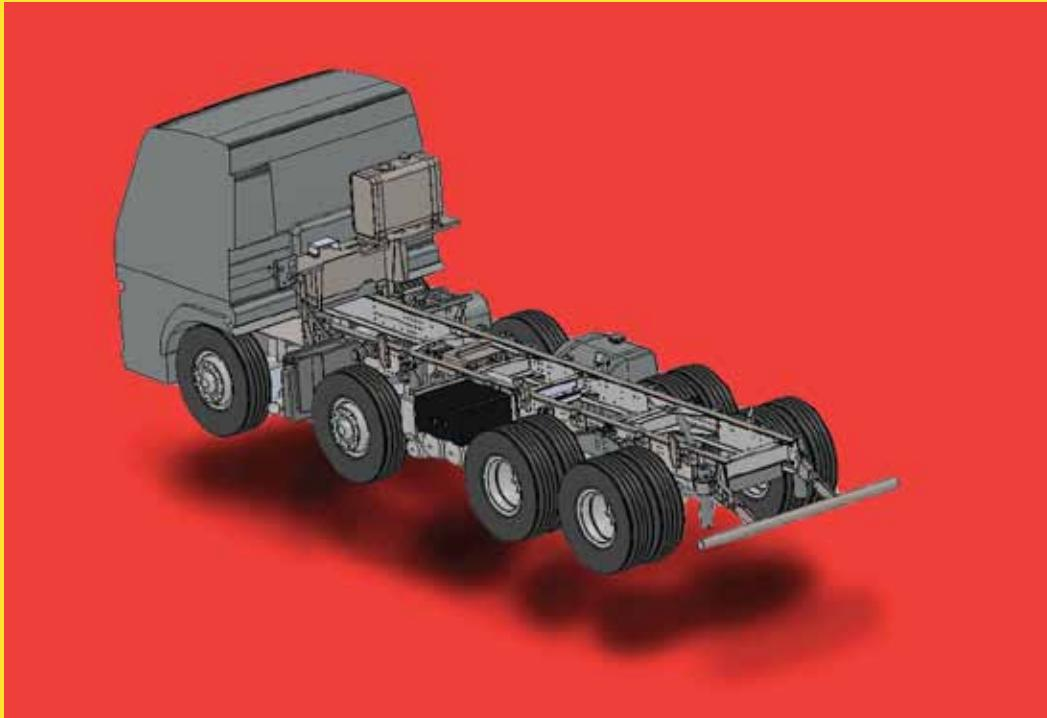
Maināma sistēma ļauj vienai automašīnai uzstādīt vairākas dažādas iekārtas, piemēram, betona vedamo iekārtu, pašizgāzēju, dažādas cisternas, platformu ar hidromanipulatoru un citu aprīkojumu. Šādi aprīkotai mašīnai ir daudz plašāks pielietojums, kas ļauj samazināt dīkstāves un panākt maksimālu automašīnas noslogojumu. Dīkstāves autotransportā nes zaudējumus, bet noslogota automašīna atpelna sevi un nes peļņu uzņēmumam.
